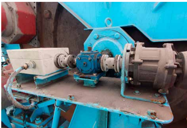
Alte Lösung mit Verteilergetriebe.
