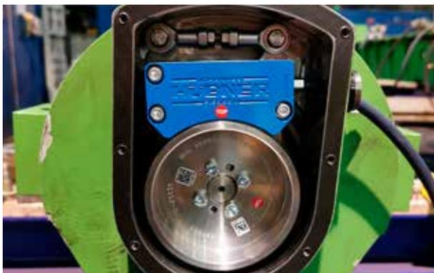
Umgebaute Schlingenheberrolle mit Magnetgeber (Polrad und Abtastkopf) und neuem Gehäuse für das Korbrollenlager.
