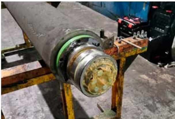
Geöffnetes Korbrollenlager. Anbau der Adapterwelle über die stirnseitigen Sechskantschrauben.
