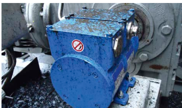
Nachher: Das direkt angetriebene Universal-Drehgeber-System U-ONE-SAFETY-Compact ermöglicht hochgenaues und sicherheitszertifiziertes Überwachen und Schalten von Endpositionen.
