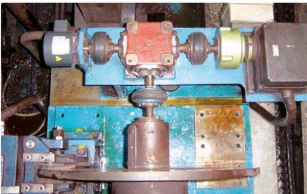
*Vorher: Der Drehgeber- und Nockenschaltwerk-Anbau über Verteilergetriebe und Zusatzkupplungen verursacht Regelungenauigkeiten durch mechanisches Spiel.*
