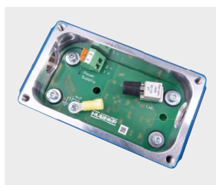
LWL-Stecker im Klemmkasten FOC connector in a terminal box
