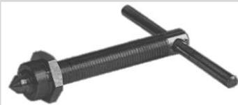
Spezialwerkzeug: Abziehvorrichtung D-53663
