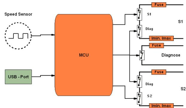
Die Schalter sind Schließer. Beim Anlegen der Betriebsspannung und fehlerfreier Funktion des EGS(H) 41 schließt der Schalter Diagnose. Die Schalter S1 und S2 werden abhängig von den eingestellten Drehzahlparametern geschaltet. Ab jetzt arbeiten die Schalter, wie im „Blockdiagramm“ dargestellt, als Öffner. Den Schaltern S1 und S2 ist jeweils ein separater Diagnoseschalter in Serie geschaltet, sodass ein sicheres Abschalten möglich ist.
