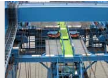
Katzfahrwerk mit Seilzugantrieb Trolley with rope winch drive
