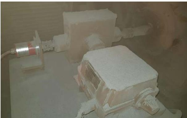
*Vorher: Mechanisches Kopierwerk und Absolutwert-Drehgeber angebaut mit einem zusätzlichen Verteilergetriebe.*
