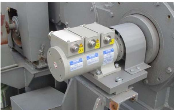
*Nachher: Elektronische Positionsschalter und Absolutwert-Drehgeber in einem Gerät direkt angebaut ohne Verteilergetriebe.*
