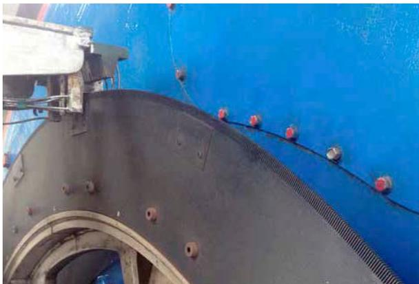
*Vorher: Die Auflösung der induktiven Zahnradabtastung reicht für eine hochpräzise Drehzahlregelung nicht aus.*
