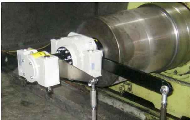
Schlüsselfertige Drehgeber-Modernisierung durch Engineering-Support-Paket mit Aufmaß, Konstruktion, Montage und Inbetriebnahme-Unterstützung.
