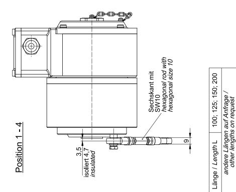
Durer renguns on request Abziehvorrichtung nach ZS-109649 nur nach Bestellung! *pull-off device acc. to ZS-109649 optional!*
