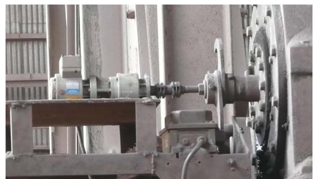
**Tratamiento de material / volquete:** bloque de rodamientos con absoluto acoplado encoder AMN (interfaz DeviceNet)
