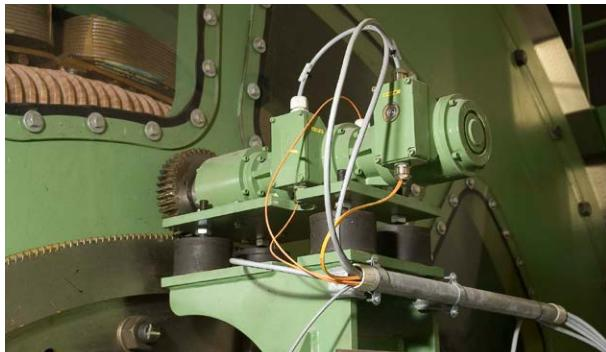
**Minería / máquina extractora:** bloque de rodamientos con encoder incremental redundante FG 40 KK y encoder absoluto AMN L (interfaz DeviceNet con conexión FOC)
