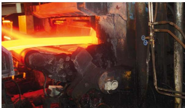
**Trenes de laminación calientes / Looper:** encoder absoluto ALS con interfaz SSI en diseño especial de looper robusto (p ej., rodamientos y eje reforzados)
