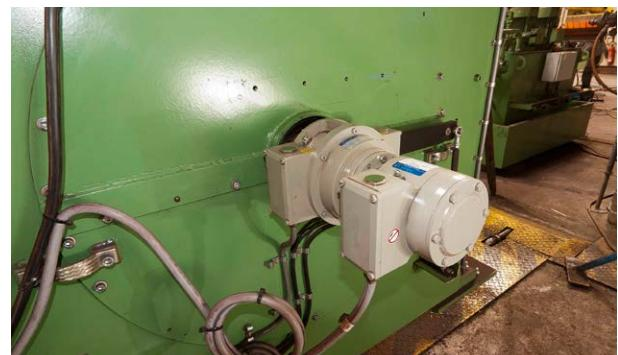
**Trenes de laminación calientes / accionamiento principal:** encoder absoluto de eje hueco ASPAH 60 (interfaz paralela) switch de sobre velocidad electrónico EGS 40 acoplado
