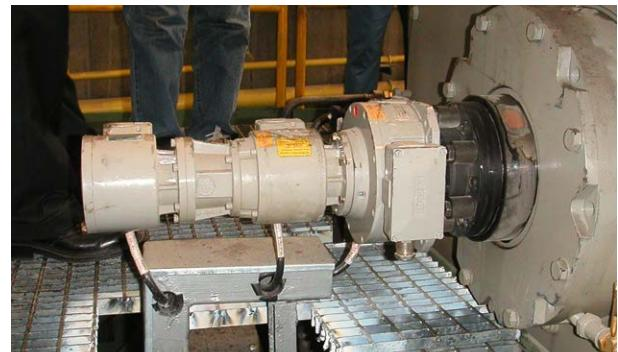
**Trenes de laminación calientes / accionamiento principal:** encoder incremental de eje hueco FGH 6, switch de sobrevelocidad electrónico EGS 40, y encoder absoluto AMS (interfaz SSI)
