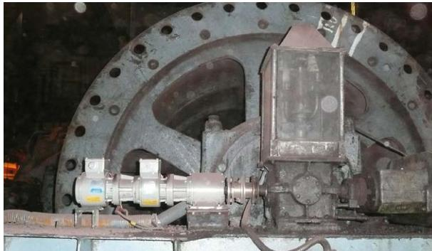
**Fabricación de acero / Skip car:** bloque de rodamientos con encoder incremental FG 40 y encoder absoluto AMS (interfaz SSI)
