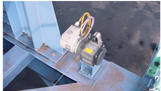
**Tratamiento de material / cinta transportadora:** transmisor por cable con encoder absoluto AMP acoplado (interfaz PROFIBUS)
