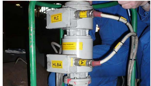
**Trenes de laminación / ajustes:** encoder absoluto AMSI (interfaz SSI y salida incremental) y encoder absoluto AMS acoplado (interfaz SSI)
