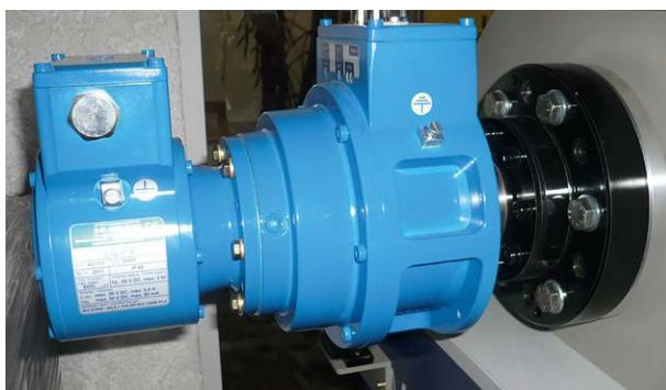
**Trenes de laminación / accionamiento principal:** encoder absoluto de eje hueco ASPHA 60 (interfaz EtherCAT) y conmutador de sobrevelocidad electrónico EGS 41 acoplado
