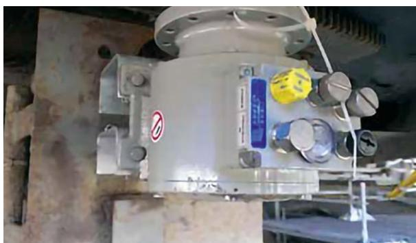
**Excavadora / engranaje de giro:** encoder absoluto AMPN 41 (PROFIsafe por PROFINET, SIL 3/PL d)
