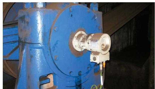
**Empresa de suministro de energía / prensa de briquetas:** encoder absoluto ASPN (interfaz PROFINET IO)
