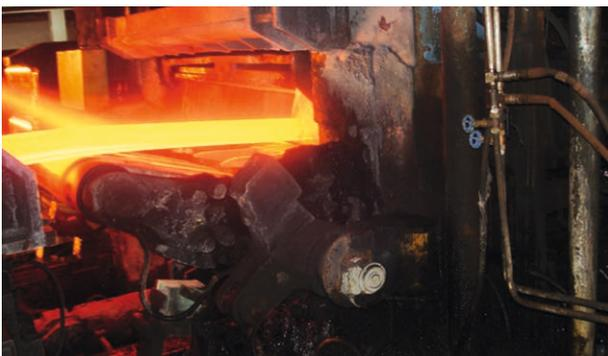
热轧/活套: 绝对值编码器 ALS 带有 SSI 接口, 为极端恶劣的活套位置设计 (例如轴承和加固的轴)
