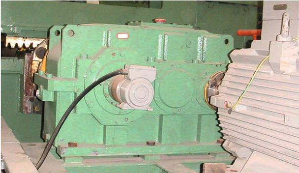
热轧/侧导板: 绝对值编码器 AMS (SSI 接口)
