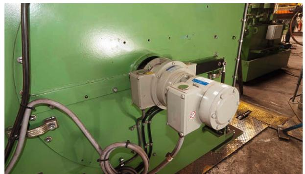
热轧/主传动: 空心轴绝对值编码器 ASPAH 60 (并行接口), 带电子超速开关 EGS 40
