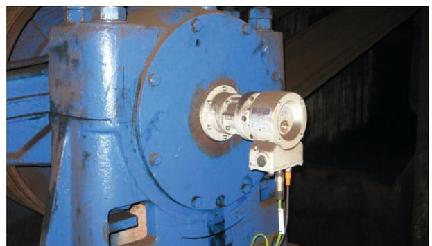
能源供应公司/压块机: 绝对值编码器 ASPN (接口 PROFINET IO)
