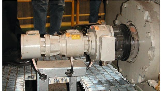
热轧/主传动: 空心轴增量编码器 FGH6, 电子超速开关 EGS40 和绝对值编码器 AMS (SSI 接口)
