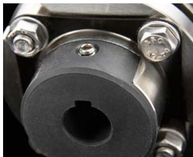
Vermeidung von Lagerschäden durch Wellenströme dank Isolierung aus glasfaserverstärktem Kunststoff. (Nicht bei Ex-Anwendungen.)
