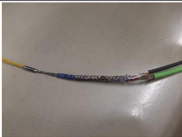
**Abbildung 1** Einziehsystem für 2 Kabel
