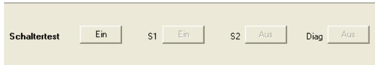
Im unteren Bereich der Seite können Sie die Funktion der Schaltausgänge des angeschlossenen Geräts testen.
