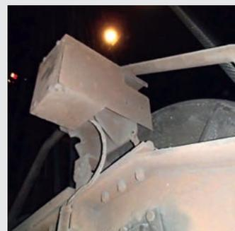
Der Generator DSG P 63.07-4 nutzt die Drehbewegung der Seil- rollen einer Krantraverse als Energiequelle.
