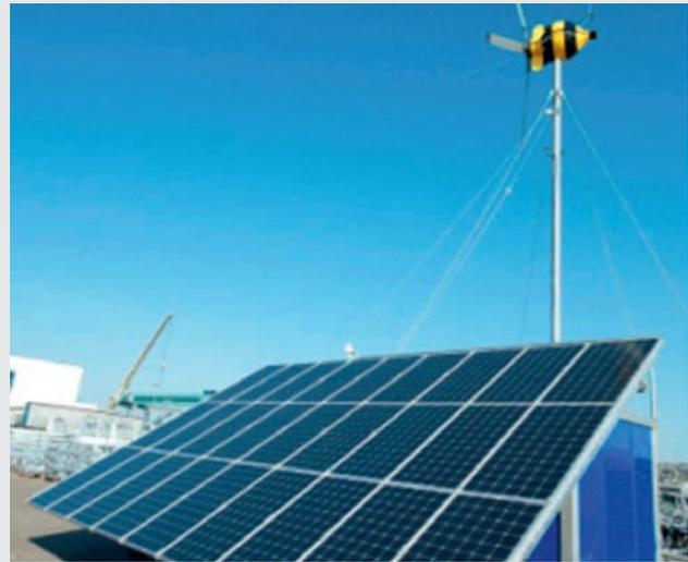
Die Firma WES Energy GmbH hat eine Kleinwindenergieanlage (5 kW/11 m/s) realisiert, die nach einer ausführlichen Testphase (ab 2005) zur Serienreife gelangt ist. In das Antriebssystem wurde ein Generator von Johannes Hübner Giessen integriert, der die mechanische Energie (Drehbewegung) umwandelt, die über einen Wechselrichter in das 230-V-/50-Hz-Netz eingespeist wird.
