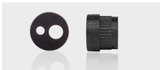
Уплотнение с 2 отверстиями для кабелей Ø 8 мм и Ø 5 мм; подходит для прокладки двух кабелей через кабельный ввод
