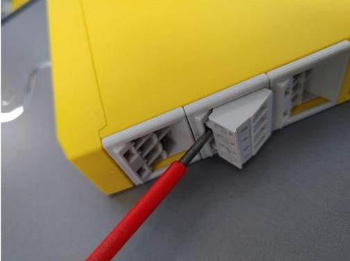
2. Zuerst werden die einzelnen Module demontiert. Um die Fixierung an der Hutschiene zu lösen, muss die Sicherung nach unten gezogen werden. Dazu wird von unten z.B. ein Schraubendreher verwendet.
