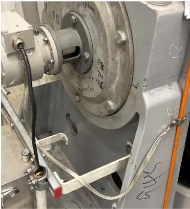
Abbildung 12: Anschluss des Erdungsbands an einen Erdungspunkt
