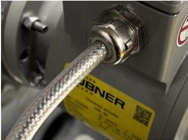
Abbildung 7: Original EMV-Kabelverschraubung am USL(H) 42 Basisgerät
