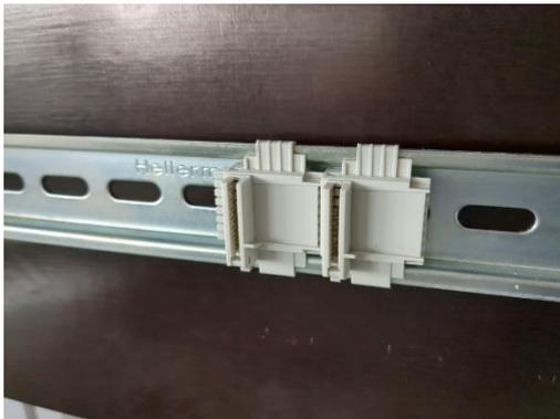
3. Module einzeln montieren. Diese werden dazu von oben auf der Hutschiene aufgesetzt und anschließend eingeschwenkt. Es ist darauf zu achten, dass die Module einrasten.
