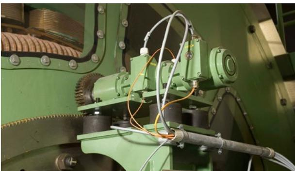
**Горнодобывающая промышленность / Подъемная шахтная машина:** блок подшипников с инкрементальным энкодером FG 40 KK с резервированием и абсолютным энкодером AMN L (интерфейс DeviceNet с подключением по оптоволокну)
