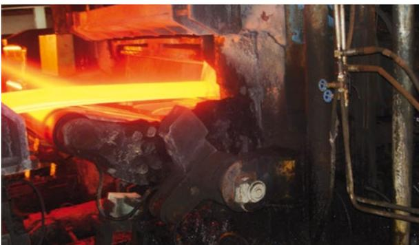
**Стан горячего проката / Петлевое устройство:** абсолютный энкодер ALS с интерфейсом SSI в специальном прочном исполнении для петлевого устройства (например, усиленные подшипники и усиленный вал)
