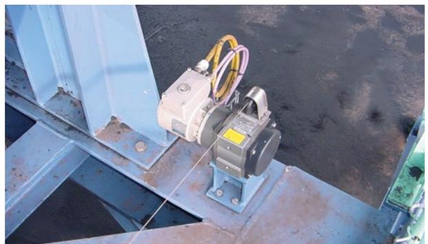
**Погрузочно-разгрузочные работы / Ленточный конвейер:** датчик длины троса в комбинации с абсолютным энкодером AMP (интерфейс PROFIBUS)
