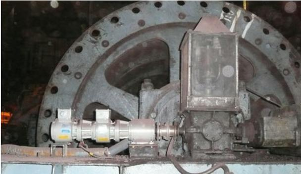
**Производство стали / Скиповая тележка:** блок подшипников с инкрементальным энкодером FG 40 и абсолютным энкодером AMS (интерфейс SSI)
