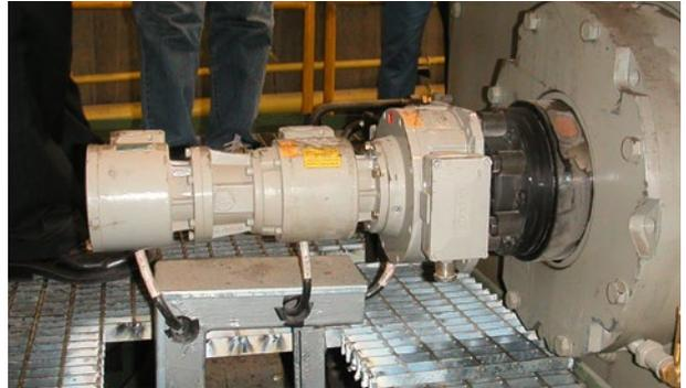
**Стан горячего проката / Главный привод:** инкрементальный датчик с полым валом FGH 6, электронный ограничитель скорости EGS 40 и абсолютный энкодер AMS (интерфейс SSI)
