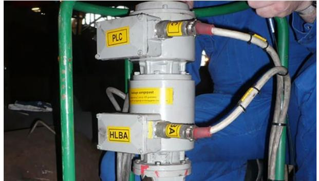
**Прокатный стан / Нажимной механизм:** абсолютный энкодер AMSI (интерфейс SSI и инкрементальный выход) в комбинации с абсолютным энкодером AMS (интерфейс SSI)
