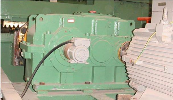
**Стан горячего проката / Боковые направляющие:** абсолютный энкодер AMS (интерфейс SSI)
