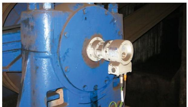
**Энергоснабжающая компания / Брикетировочный пресс:** абсолютный энкодер ASPN (интерфейс PROFINET IO)
