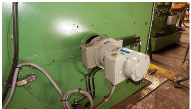
**Стан горячего проката / Главный привод:** абсолютный энкодер с полым валом ASPAH 60 (параллельный интерфейс) в комбинации с электронным ограничителем скорости EGS 40
