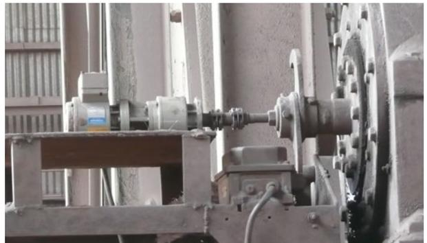
**Погрузочно-разгрузочные работы / вагонопрокидыватель:** блок подшипников в комбинации с абсолютным энкодером AMN (интерфейс DeviceNet)
