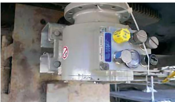
**Экскаватор / Поворотный механизм:** абсолютный энкодер AMPN 41 (PROFIsafe через PROFINET, SIL 3/PL d)
