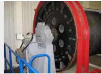
U-ONE® Multiturn Basisgerät mit mechan. Getriebe-Nockenendschalter U-ONE® Multiturn basic unit with mechanical geared cam limit switch
