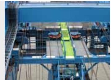
Katzfahrwerk mit Seilzugantrieb Trolley with rope winch drive
