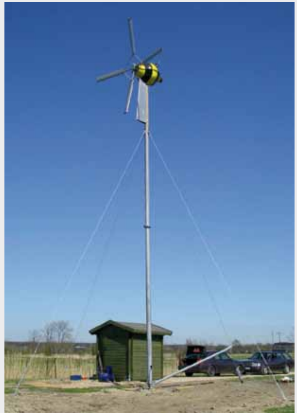
Vierblättrige 5 kW Anlage mit Lee-Läufer Prinzip (Beispiele mit freundlicher Genehmigung von WES)/5 kW system with downwind principle (Examples courtesy of WES)
